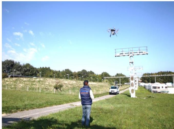
La instalación de los sistemas de inspección de señal en el espacio de radioayudas (SIS) en aeronaves RPAS permite ampliar el alcance y las posibilidades de las mediciones en tierra, brindando beneficios tanto al Proveedor de Servicios de Navegación Aérea, como a la Autoridad Aeronáutica en la certificación y extensión de periodos de certificación de radioayudas con el avión de inspección, entre ellos:
